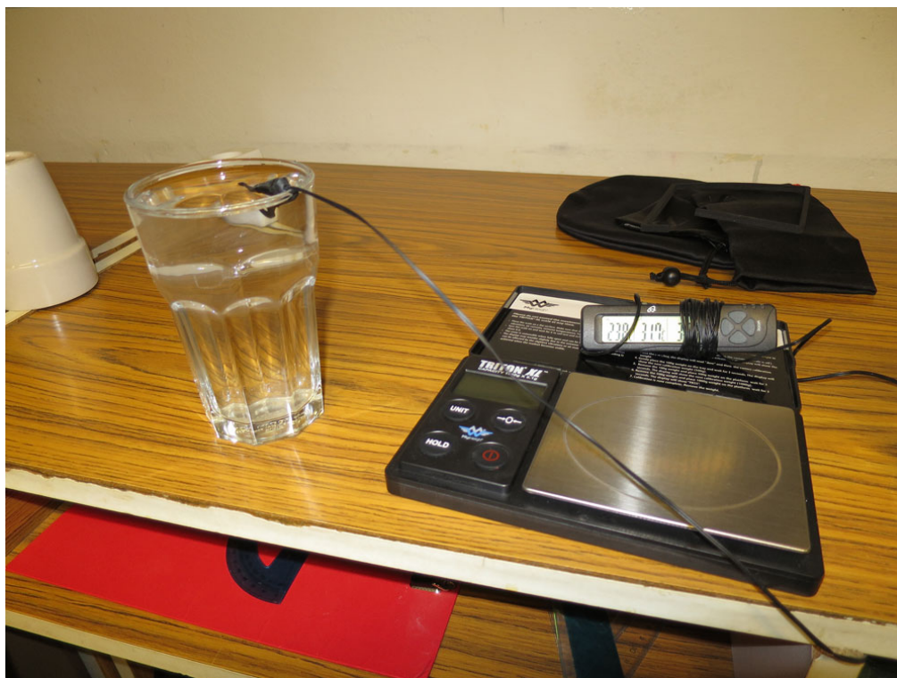
Obrázok 2: Experimentálna aparatura: pohár s vodou a digitálna váha. Teplota vody je práve meraná digitálnym teplomerom
